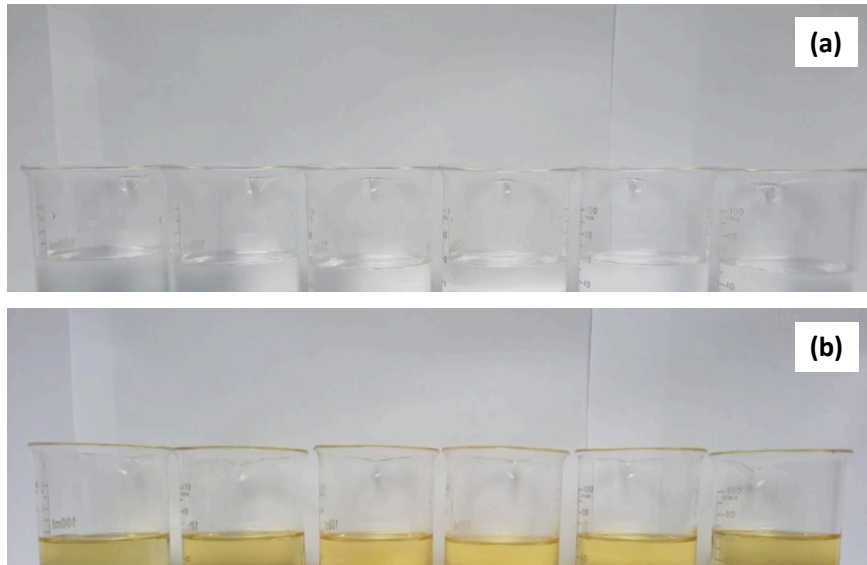
Figura 9 – Amostras coletadas durante a operação de separação em diferentes tempos: (a) saída de água e (b) saída do óleo
