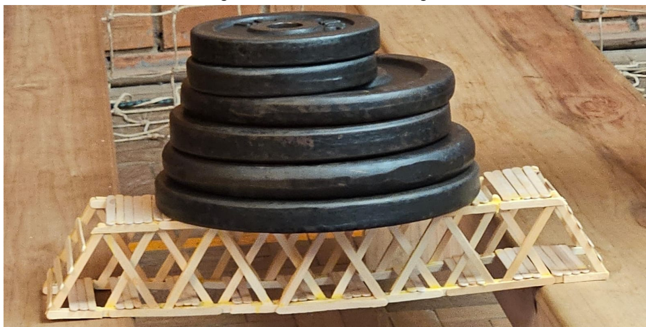
Figura 5 – Ponte em teste de cargas
