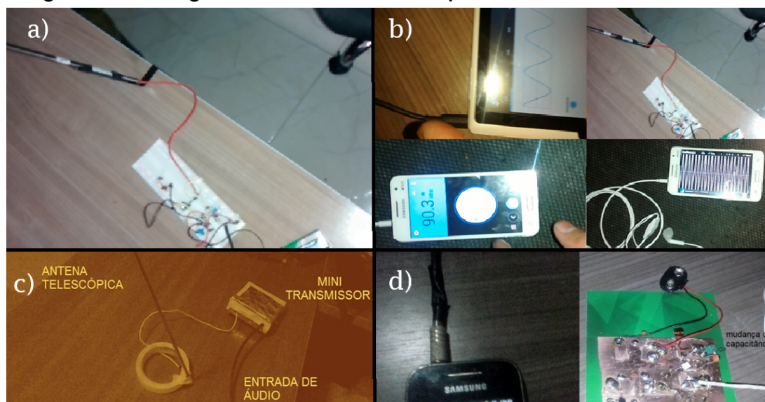
Figura 15 – Montagem e funcionamento do experimento de transmissão em FM
