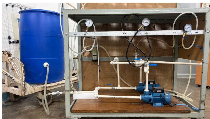
Figura 4 – Sistema experimental construído para estudo de bombas em diferentes configurações
