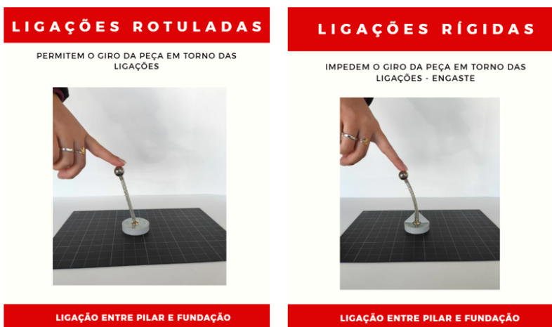
Figura 3 – Representação das ligações rotuladas e rígidas com Kit Mola
