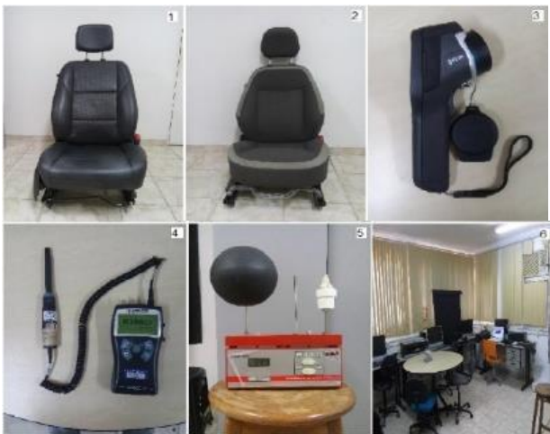
Figura 4 – Materiais utilizados na pesquisa. (1) Banco de Napa; (2) Banco de Tecido; (3) Câmera Termográfica FLIR E-60; (4) Multifuncional AMI 300; (5) Termômetro digital TGD-200; (6) Laboratório de testes LEEST.
