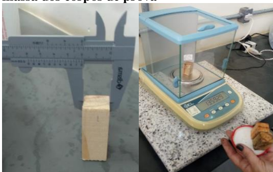
Figura 4 – Aferição e registro das dimensões e da massa dos corpos de prova
