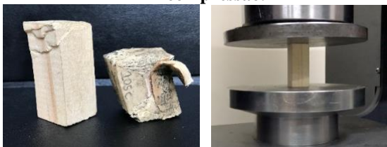
Figura 5 – Corpos de prova submetidos ao ensaio de compressão.
