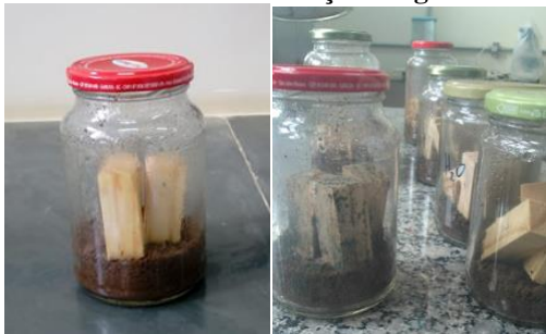
Figura 3 – Corpos de prova no 1º dia e após 72 dias de inoculação fúngica.
