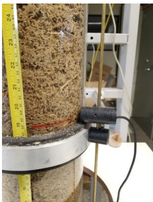
Figura 5 – Instalação dos indicadores de nível construídos na parte externa da coluna.
