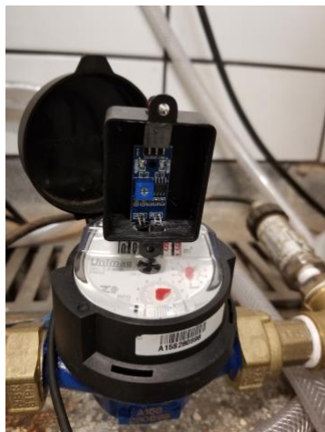
Figura 3 – Medidor de vazão construído.
