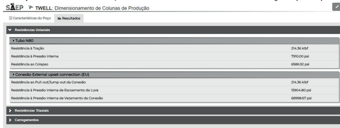
Figura 8: Saída para resistências uniaxiais/biaxiais do Tubo 1 no estudo de caso no TubingWell (TWELL)
