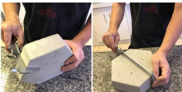
Figura 2 – Ensaio de verificação dimensional dos pavers produzidos.
