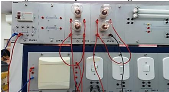
Figura 2 – Kit disponibilizado e algumas atividades de ambientação com montagens de circuitos
