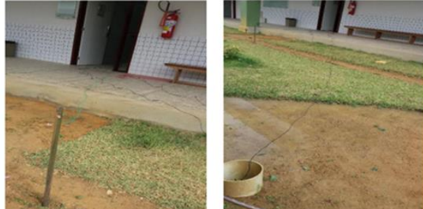
Figura 4 – Circuito, haste auxiliar e eletrodo para estimativa da resistência de aterramento
