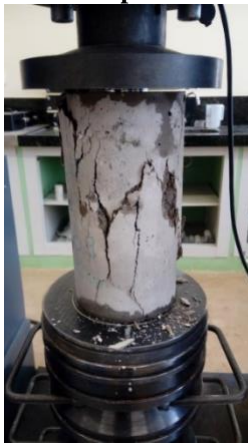
Figura 4 – Ensaio de rompimento de corpo de prova
