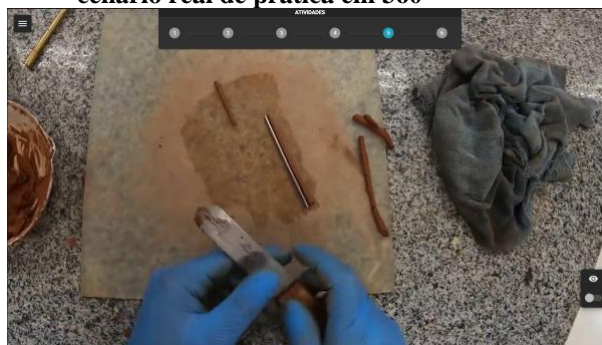
Figura 10 – Ensaio Limite de Plasticidade LVA cenário real de prática em 360°
