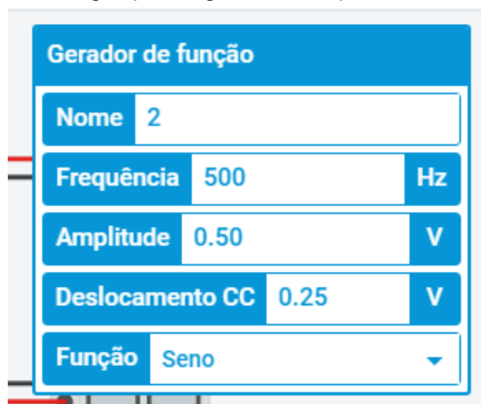
Figura 12 - Configurações do gerador de função com o deslocamento.
