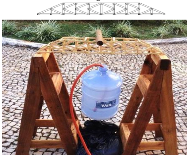
Figura 5 – Protótipo de ponte durante um teste de carga
