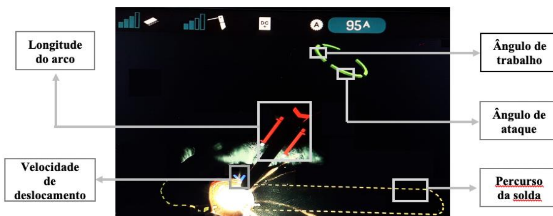
Figura 4 – Sinais ópticos indicativos da posição do eletrodo em relação à peça de trabalho
