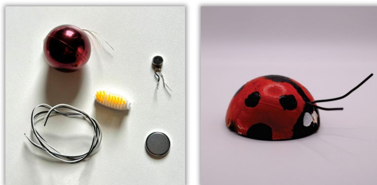
Figura 3 – Materiais utilizados e protótipo inicial do Joanelinha Maluca, brinquedo sustentável desenvolvido a partir de componentes eletrônicos reciclados
