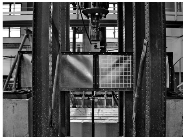
Figura 7 - Teste experimental de uma viga em laboratório (flambagem por cisalhamento), chamado campo de tração.
