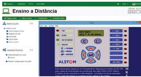
Figura 10: Simulador de relés digitais P442 (MiCOM Agile, 2011).
