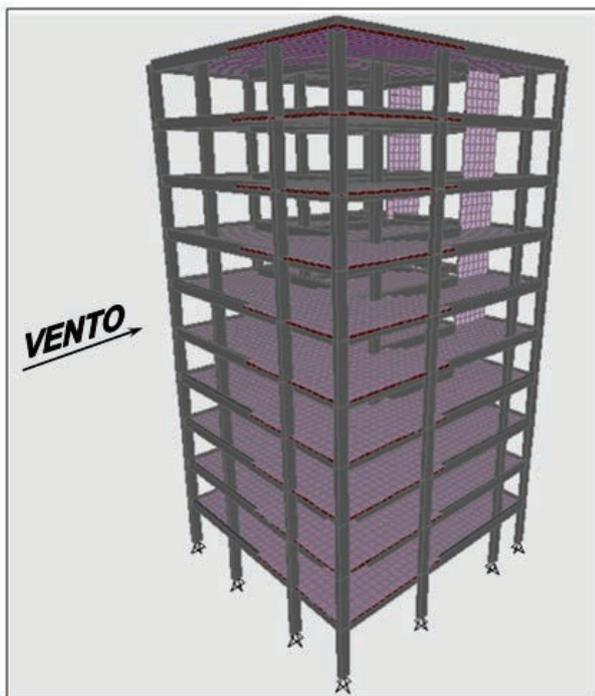
Figura 5: Modelo de estrutura tridimensional.
