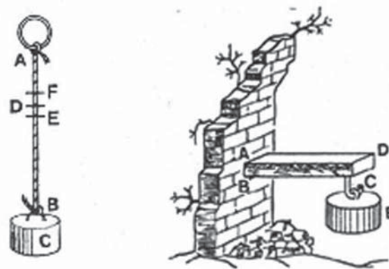
Figura 3 - Resistência de corpos sólidos à ruptura: ilustração da esquerda – um caso de tração simples, exercida por uma força longitudinal. Ilustração da direita – uma trave onde ocorre uma flexão causada por uma força transversal. Galileo compreendeu experimentalmente que a resistência à tração de fios ou cabos de um mesmo material é proporcional à área de sua seção transversal e não depende do seu comprimento. Ele concluiu que, no caso de o esforço de tração derivar apenas do peso próprio o fio, existe para cada material um comprimento limite ou comprimento de ruptura. (Figura extraída de GALILEI, 1988, p. 121 e 116, respectivamente)
